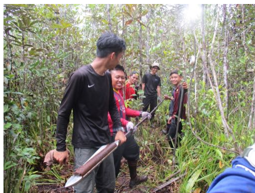
図27. ドーム頂上でのコアリング。 採取された泥炭コアが手前にみえる.
