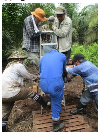
図8. マルディーサイトにおけるシンウオールピストンコアラーによる泥炭コア採取.
